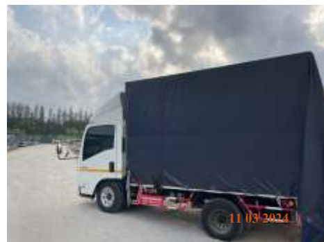
ภาพที่ 2-3 ผ้าใบปิดคลุมท้ายรถบรรทุกในการขนส่งวัสดุก่อสร้าง
